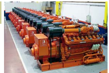
Grupos generadores de gas natural en fábrica antes de expedición
