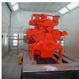
Cabina de Pintura
